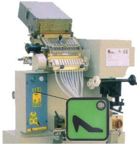
将鞋放在鞋座上并用一只手紧紧地抓住鞋后跟，踩下脚踏开关使下压杆降下，鞋底和后跟被机械固定了。
