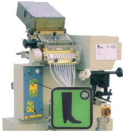
因铰链顶座杆会向自己面前倾斜过来，因此操作者必须用手抓住它，然后将靴子安放在支架顶座块上，并用手推回到原始位置。定位好靴子后，踩下脚踏开关使下压杆以低压落下来固定后跟和鞋底，然后用双手同时按下位于鞋座旁边的两个控制杆，开始打钉操作。打钉操作完成，铰链顶座就会向操作者面前倾斜，以方便取下靴子。
